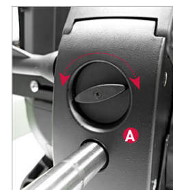
Regulador de tensión Mecanismo Syncro Auto-pesante
